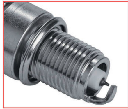
Diâmetro do eletrodo central com até 0,4mm.
